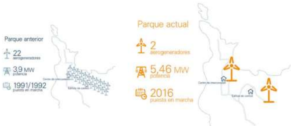
Figura 8.9. Esquema que muestra la situación del Parque Eólico de Cabo Vilano (Mañón, A Coruña) en el momento de su puesta en funcionamiento (1991/1992) y tras la ejecución del proyecto de repotenciación (2016). Imagen tomada de Landeira Suarez et al. 2017.
