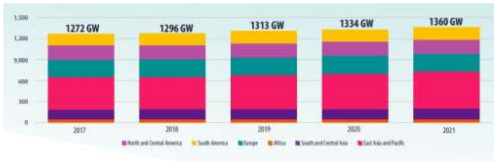
Figura 3.7. Crecimiento global de la capacidad hidroeléctrica instalada (GW) en el periodo 2017-2021. Fuente International Hydropower Association (IHA), Informe del estado de la energía hidroeléctrica de 2022.
