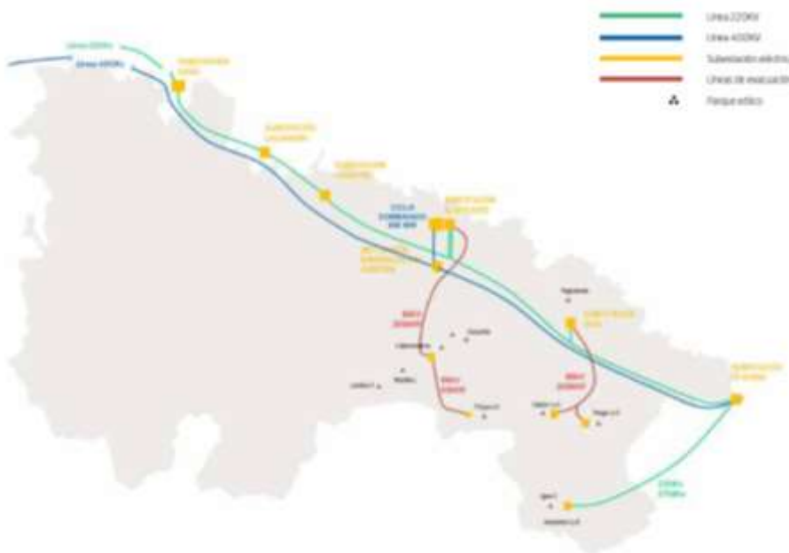
Figura 11.2. Ubicación de parques eólicos y principales subestaciones y líneas eléctricas existentes en La Rioja: Fuente: Anexo 1 de la Guía de Energías Renovables en La Rioja (2022).
