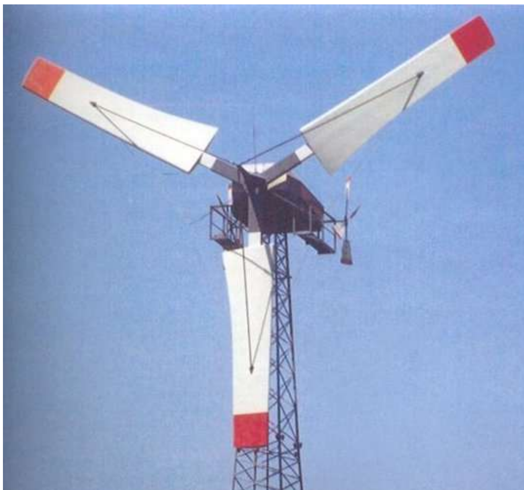
Figura 3.27. Fotografía del aerogenerador Wind Matic 14-55 (WM 14-55), fabricado en Dinamarca por Wind Matic AS. (Diámetro del rotor 14 m. Área del rotor 154 m 2 . Potencia 55 kW), instalado en 1982 en Terras de Soneira (A Coruña). El aerogenerador estuvo conectado a la red desde mayo 1983.
